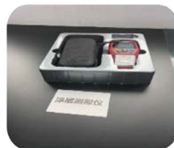
厚度检测 涂层测厚仪
